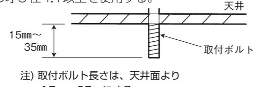
注) 取付ボルト長さは、天井面より 15mm~35mm にする。
